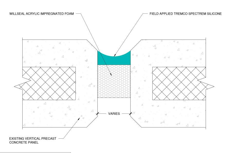
NOTE: RECESS JOINT  $\frac{1}{4}$ " FROM JOINT SURFACE.
